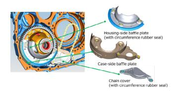
Fig. 12 Baffle plate
