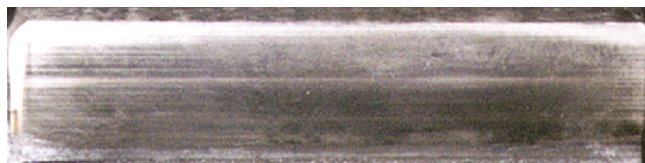
上記状態後、当初と同じ安価な潤滑油に変更、計7年経過後の状態。 現在14年を経過したがまだ全85車両の歯車は無傷
