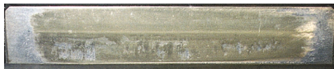
同一設計新品歯車に対し、最高の特殊潤滑油を採用し、1年稼働後の状態
