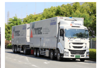
ダブル連結トラック 写真: (株) パンテック提供
