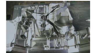
直彫り加工で製作したダイキャスト金型
