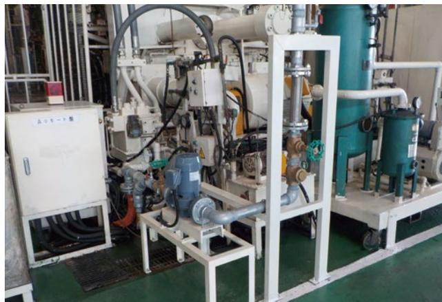
鋳造設備の冷却水循環装置
