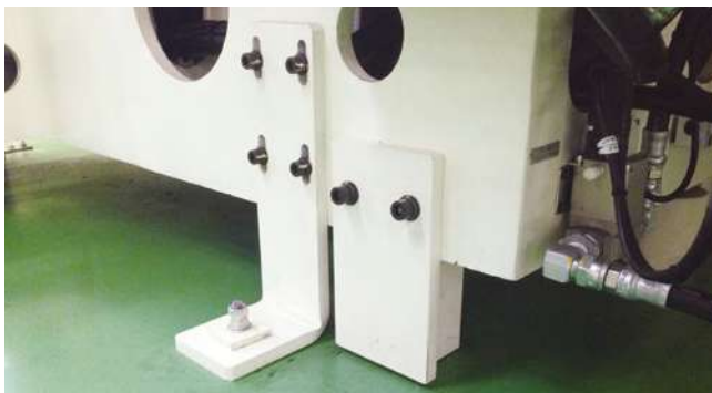
新たに付加した設備の補助脚
