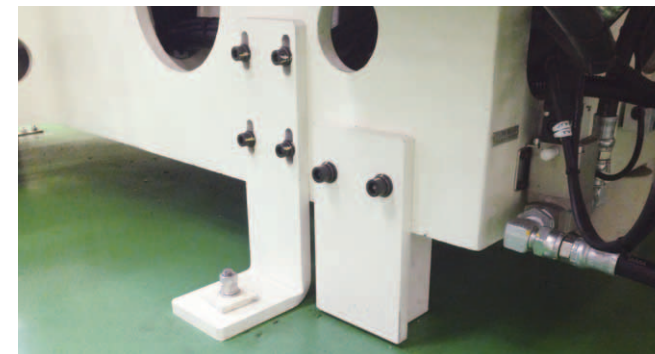
新たに付加した設備の補助脚
