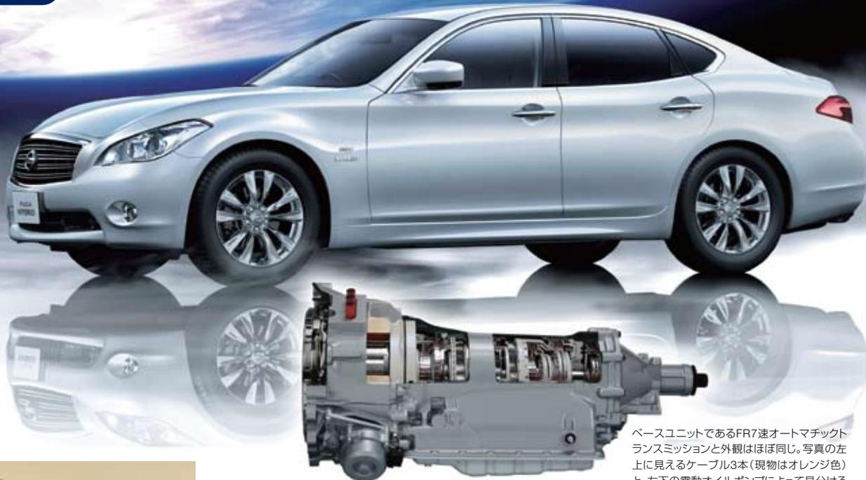
ベースユニットであるFR7速オートマチックトランスミッションと外観はほぼ同じ。写真の左上に見えるケーブル3本（現物はオレンジ色）と、左下の電動オイルポンプによって見分けることができます。
