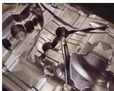
直彫り加工で製作したダイキャスト
