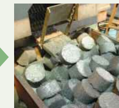
研磨カスを圧縮した製鋼原料
